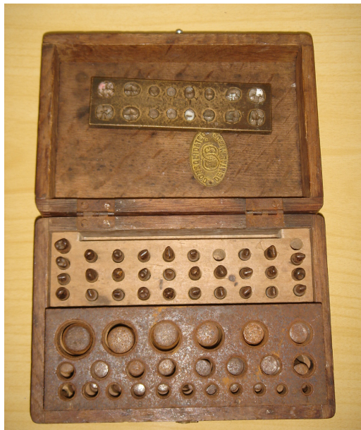
FIGs. 16 e 17. Dispositivos para confecção de coroas estampadas, utilizados pelo Dr. Killing.
